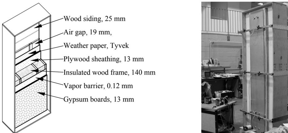
**TABLE 1. SPECIMEN CONFIGURATION FOR MOLD TEST A**
